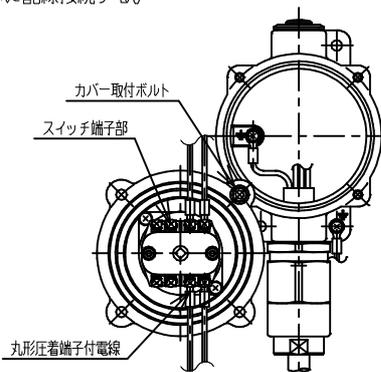
4) 配線後、本体にカバーを挿入し六角穴付ボルト (M6 SW、PW付) を六角棒スパナで締付ける。
