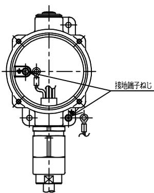
3) カバーを裏にし、カバー取付ボルトで1箇所固定してから内蔵品の端子部に配線接続する。
