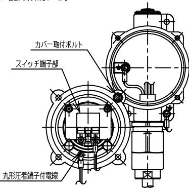
4) 配線後、本体にカバーを插入し六角穴付ボルト（M6 SW、PW付）を六角棒スパナで締付ける。
