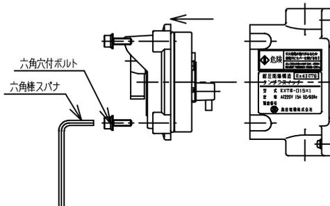
2) 耐圧パッキン式ケーブルグラウンドを取付けてからケーブルを通し電線の端末に絶縁チューブ付丸形圧着端子を取付ける。次に内部/外部耐接地端子の十字穴付なべ小ねじ (M4 SW、PW付) で接地線を取付ける。
